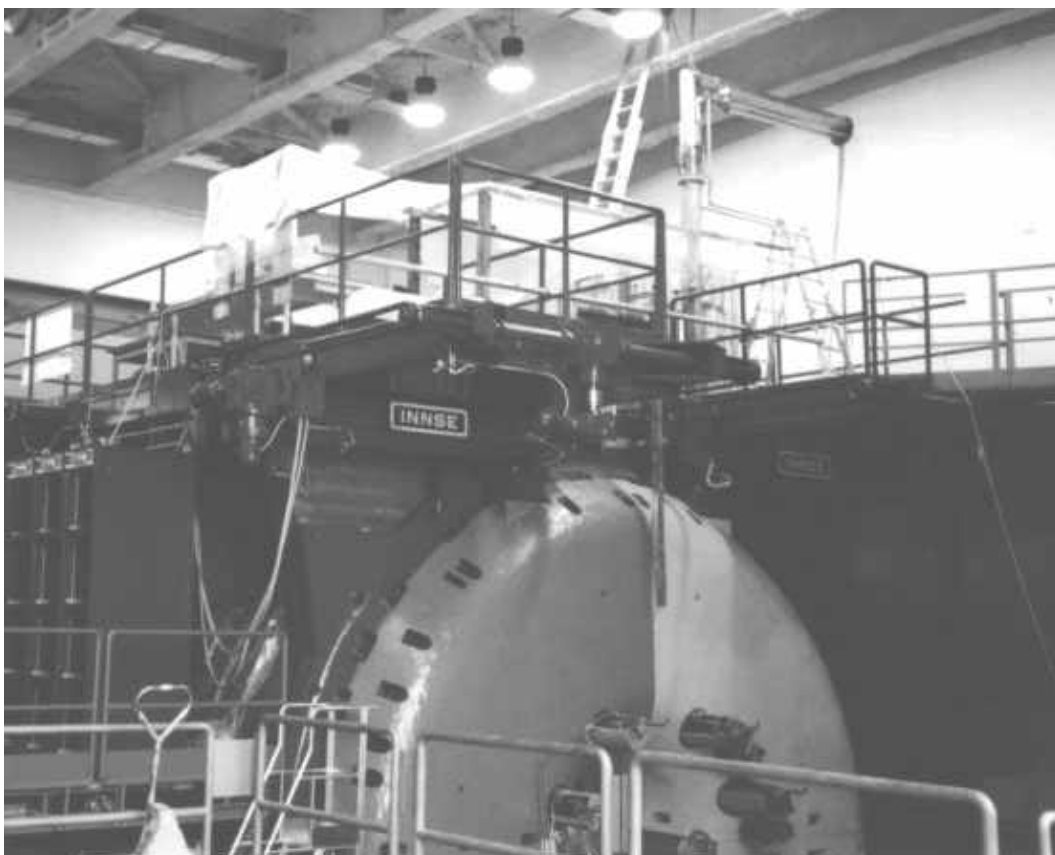
Figura 5 : Vista della parte superiore del magnete di KLOE. (È visibile l'arrivo e la connessione della Linea di Trasferimento Criogenica attraverso il muro circolare della Sala DA NE)
